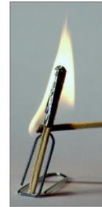
Zum Zünden wird eine Flamme einige Sekunden unter den Zündkopf gehalten. Eine feuerfeste Unterlage verhindert eventuelle Brandflecken, die durch den heißen Abgasstrahl entstehen können.
